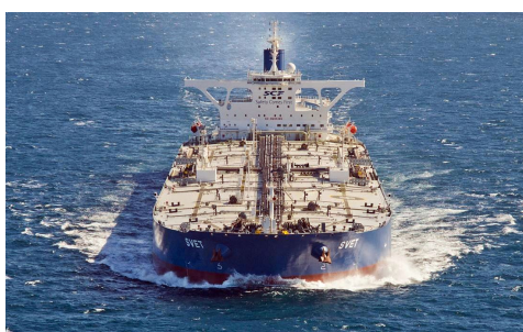
Вторую практику повезло пройти на супертанкере Svet – первого в истории российского торгового флота танкера типоразмера VLCC дедвейтом 320000 тонн
